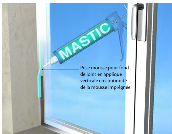
Figure 25 : Raccordement entre calfeutrement traverse basse et montant
