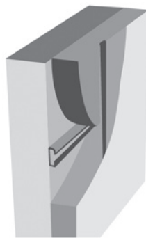
Figure 5.1 : Isolation fixée au moyen d'un appui intermédiaire
