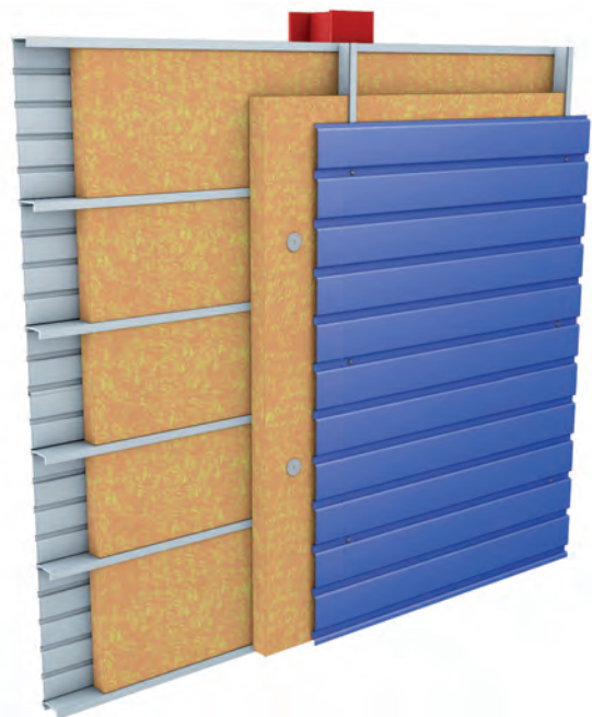
Figure 2 : Illustration de la pose d'un bardage sur plateaux métalliques avec vis simple filet (bardage traditionnel)
