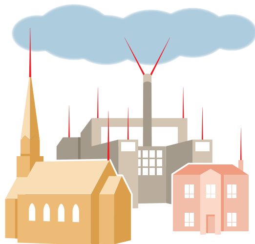
Figure 29 : Paratonnerres à tiges sur les parties hautes d'une construction
