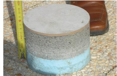
Figure 24 : La réalisation d'un carottage permet de vérifier la qualité de l'isolant et l'épaisseur de la chape. Des « vides » peuvent être mis en évidence entre la chape et le plancher porteur.
