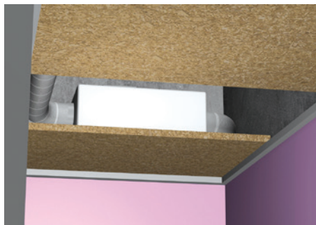
Figure 10 : Installation d'une centrale individuelle dans le plafond des WC
