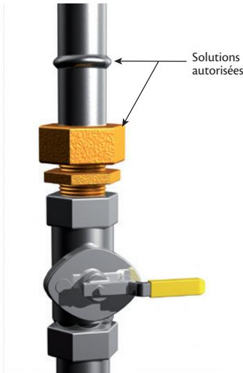
Figure 31 : Raccordement d'un accessoire taraudé
