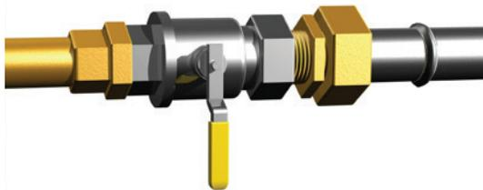
Figure 32 : Raccordement d'un accessoire taraudé entre cuivre et acier
