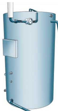
Réservoir indépendant Dans cette configuration, l'appoint dans la cuve s'effectue à l'aide d'un disconnecteur de type AB (à l'intérieur de la cuve).
