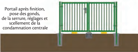
Figure 3 : Pose des portails pivotants en deux phases
