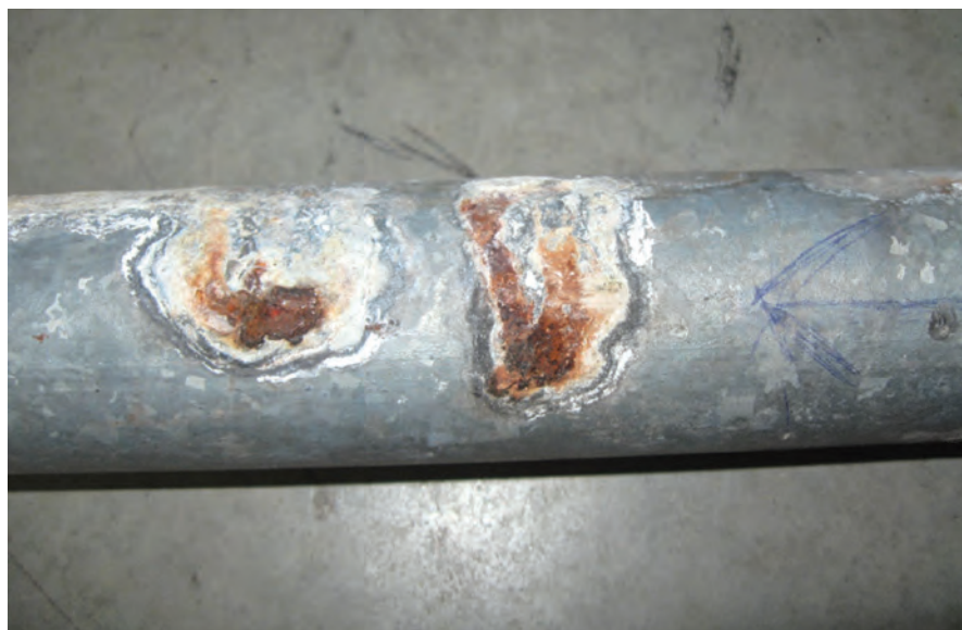
Figure 1 : Canalisation en acier galvanisé corrodée
