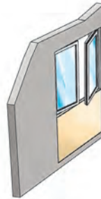
Allège formant garde-corps
