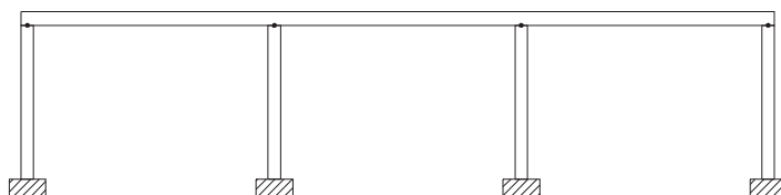
Figure 2 : Bâtiment à un niveau toiture rigide.
