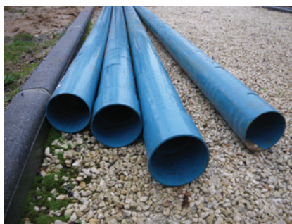
Figure 20 : Bonne pratique : collecteur drainant préconisé (MP) avec des lumières uniquement sur le dessus
