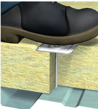
Figure 6 : Notion de « solide au pas »
