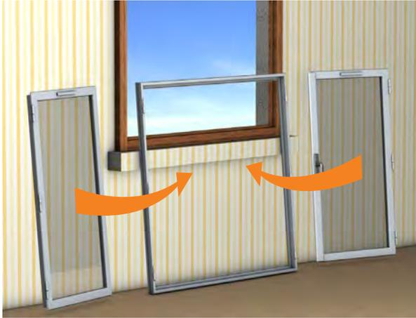
Figure 1 : Dépose des vantaux
