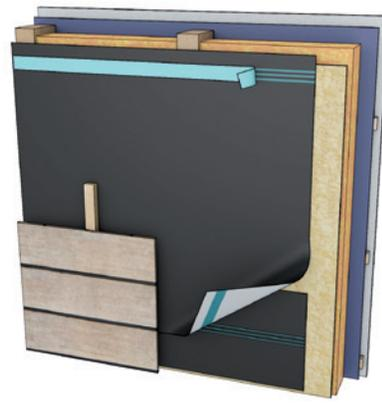
Figure 4 : Recouvrement horizontal du pare-pluie
